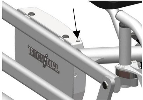
**Nota:** Pueden pasar hasta 15 segundos desde que se conecta el cable de carga hasta que se enciende el LED. La batería no se puede sobrecargar.
