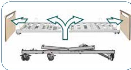
Kopf- und Fußteil, Oberkörperaufrichter und zum Schluß Beinaufrichter abnehmen.
